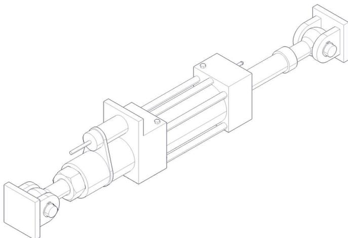
O amortecedor hidráulico é fornecido pré-montado.
