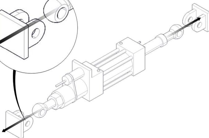
E retirar os elementos de união à viga de ambos os lados.
