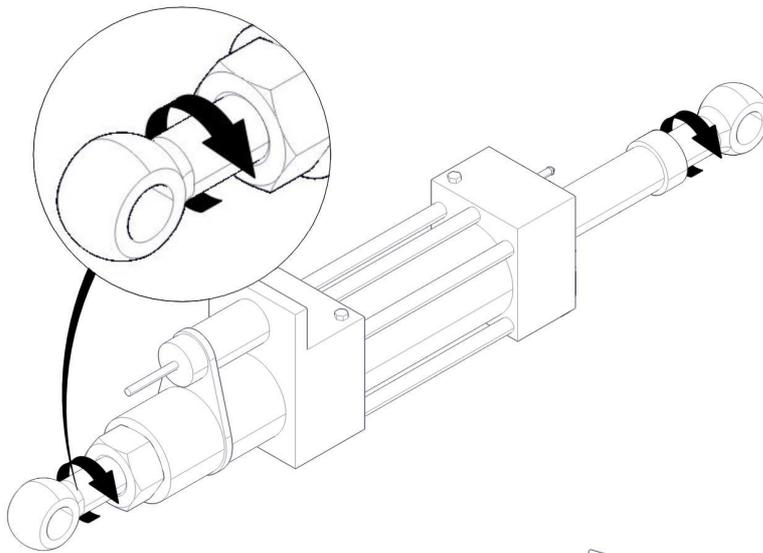
Verificar a distância entre o centro dos elementos de união à viga soldados. Se necessário, ajustar a altura da montagem do conjunto, enroscando e desenroscando as hastes.
